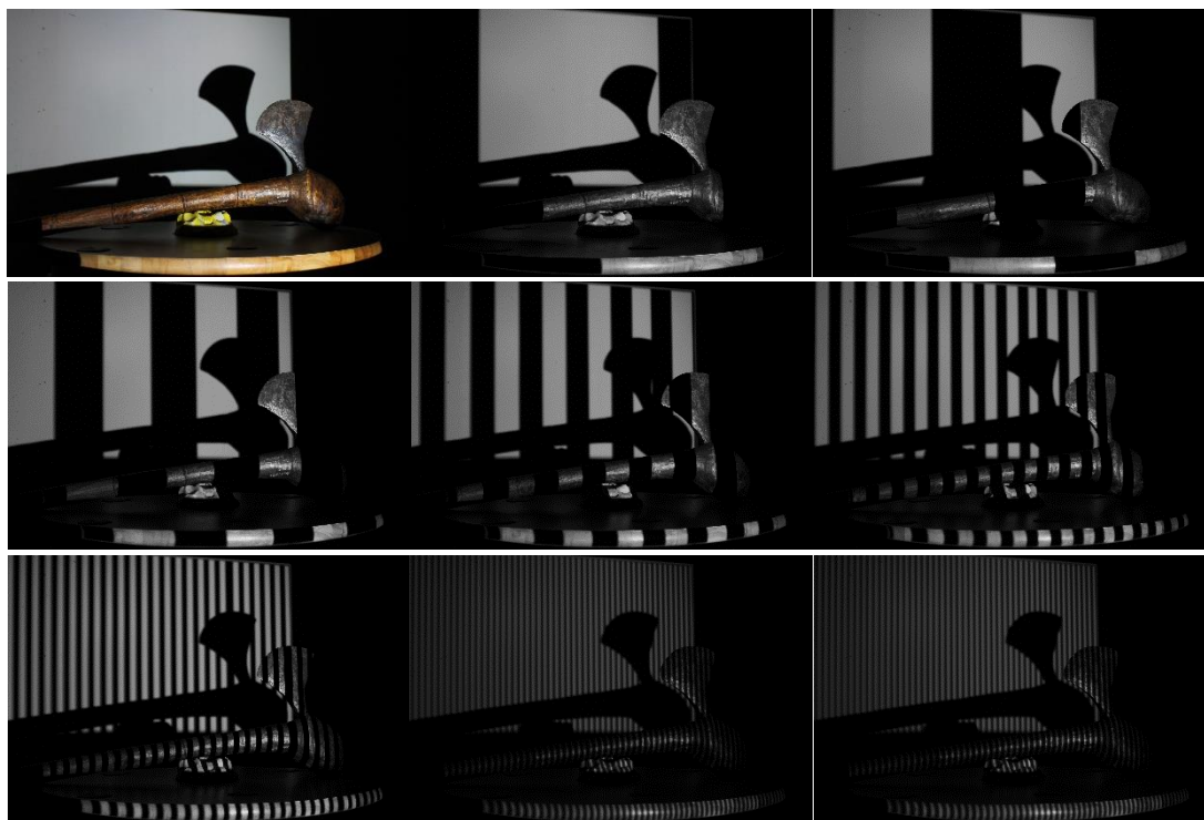
Obr. 9. Ukázka projekce vzorů při skenování. Zdroj: autor
