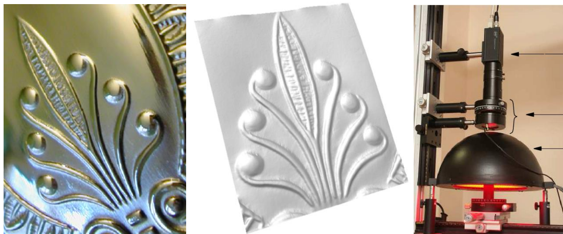
Obr. 18. Ukázka Shape from Polarisation. Originální fotografie dekorovaného kovu (vlevo) spolu s výslednou 3D rekonstrukcí (uprostřed) a prototyp polarizačního 3D skeneru (vpravo). Zdroj: Morel 2005, Fig. 5.1, 5.30a, b.
