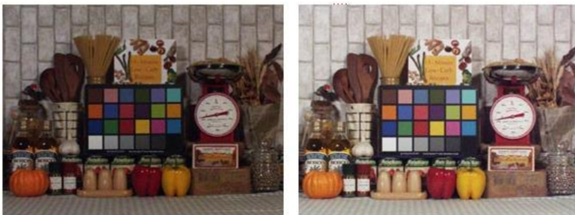
Obr. 19. Srovnání kvality obrazu CMOS senzoru (vlevo) a s CMOS BSI senzoru (vpravo) při konstantním osvětlení. Zdroj: Sony 2008.
