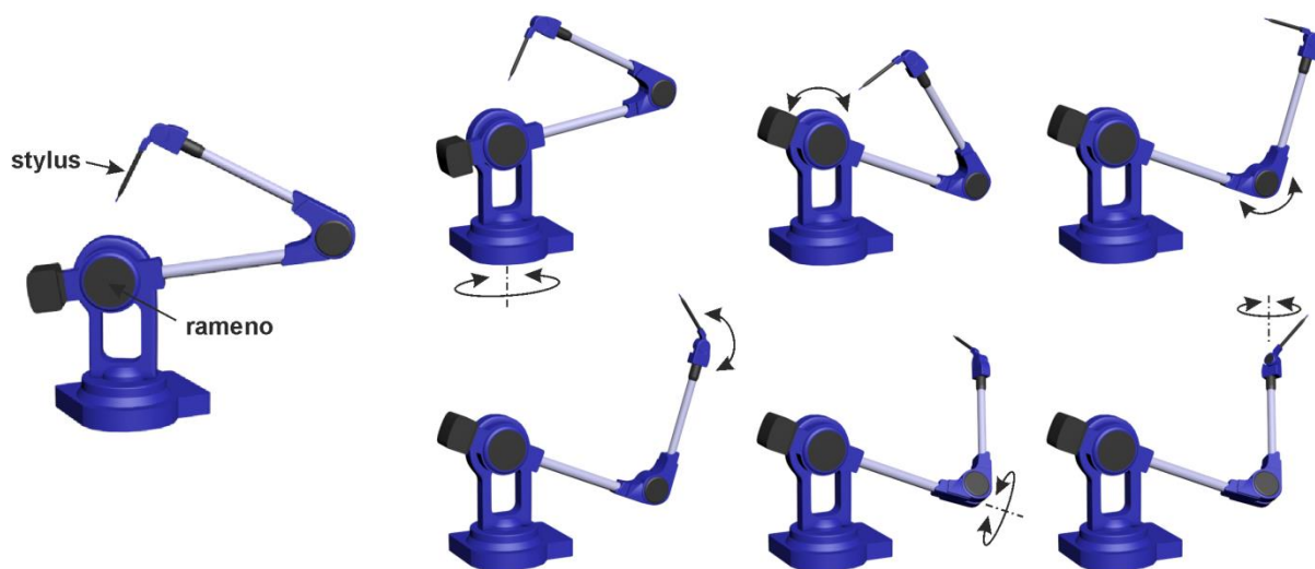
Obr. 6. 3D ramenný digitizér s vyznačenými stupni volnostmi. Zdroj: autor.
