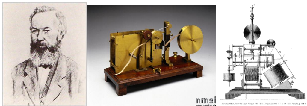
Obr. 1. Alexandr Bain (vlevo); Bainův elektricko-chemický telegraf (uprostřed); Bainův faksimilový přístroj z roku 1850 (vpravo). Zdroje: Biscutes 2010; Ingenious 2013; Rensen 2013.
