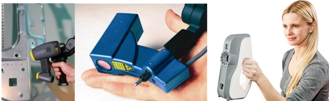
Obr. 6. Ukázka ručních a ramenných 3D skenerů. Nikon Focus Handeld (vlevo), MicroScan 3D (uprostřed) a Artec Eva (vpravo). Zdroj: NV 2013 (vlevo), GmbH 2012 (uprostřed), Group 2013 (vpravo).
