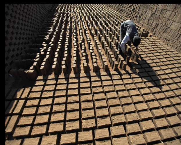
Séchage des briques
