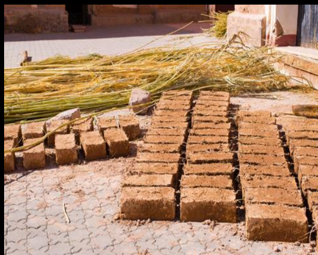
Séchage des briques
